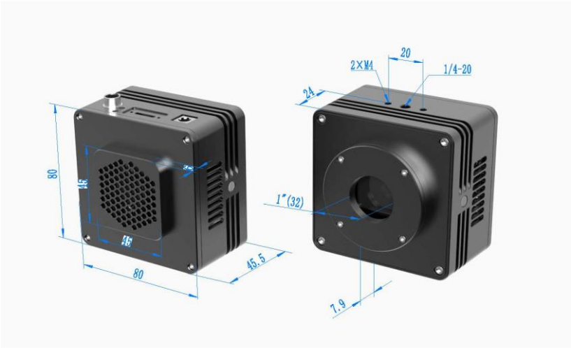
图 12-15 CTR3CMOS 整机尺寸(单位：mm)
