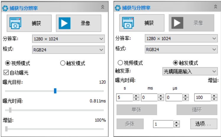
图 15-1 ToupView 中捕获与分辨率组的视频模式和触发模式
