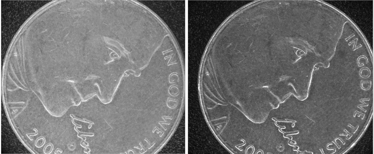
图 5-55 普通相机（左）与偏振相机（右）金属表面效果对比
