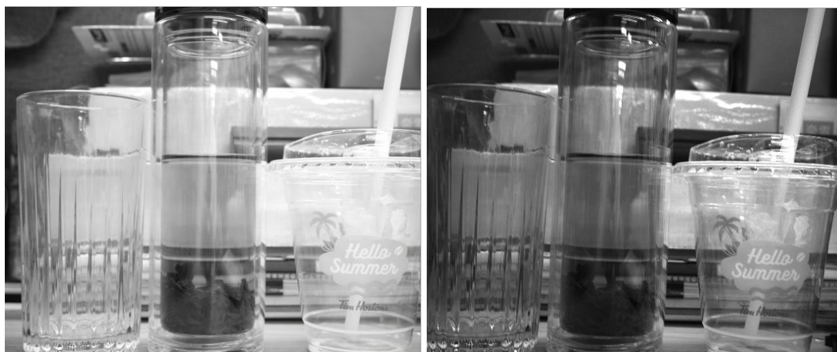
图 5-53 普通相机（左）与偏振相机（右）塑料表面效果对比
